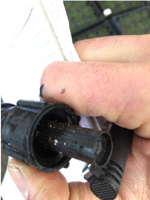
Ilustración 9. Ejemplo de aspersor TORO PRN con filtro tapado
