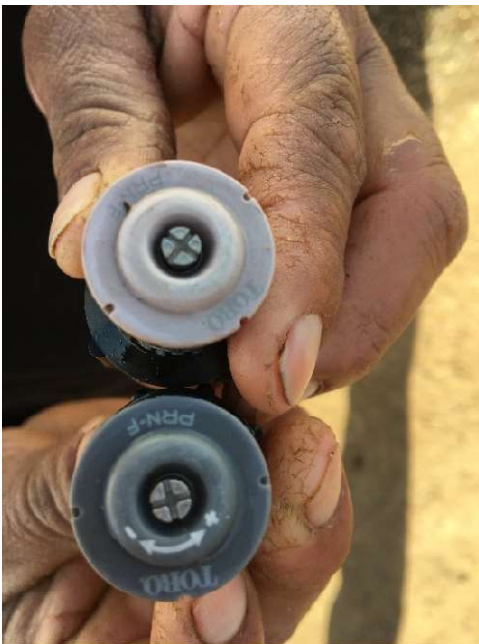
Ilustración 10. Tornillos de reducción de alcance en la parte de arriba de los aspersores TORO PRN.
