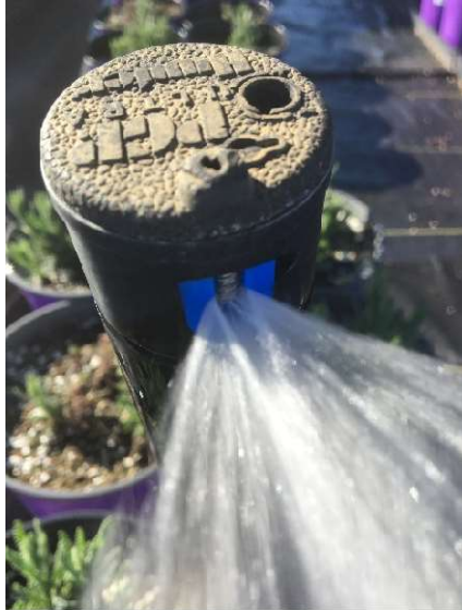
Ilustración 3. Para reducir el alcance de las boquillas de 4 gpm el tornillo está empujado todo hacia adentro.
