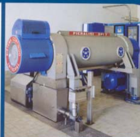
Módulo control humedad y riqueza grasa orujo.
