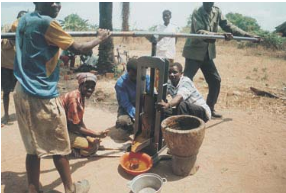
Fig. 6 Spindle press (Luapula, Zambia)
