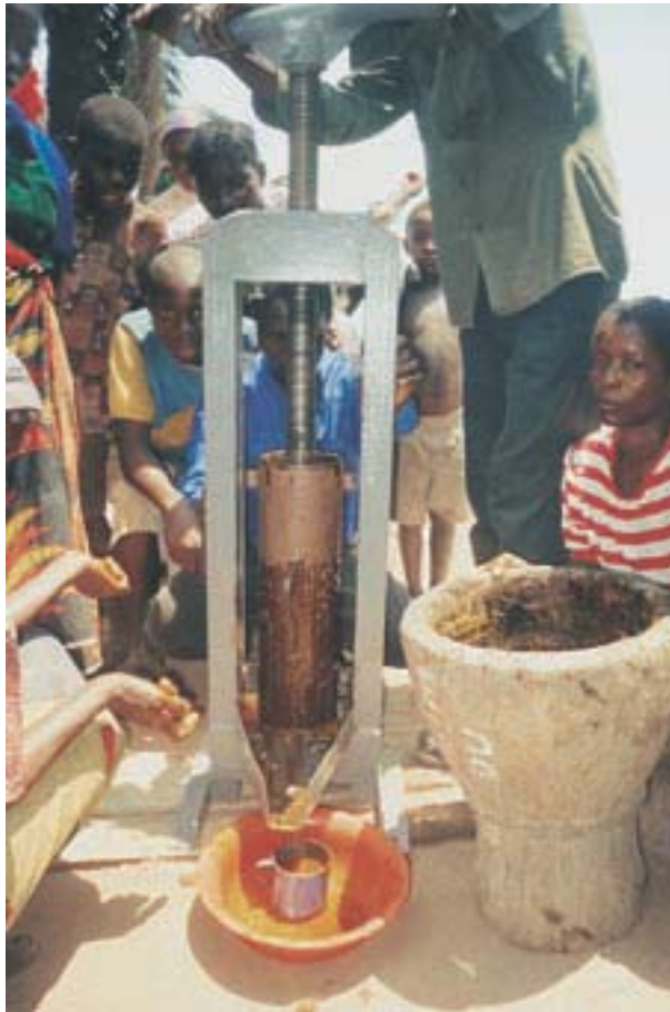
Fig. 5 Spindle press (Luapula, Zambia)
