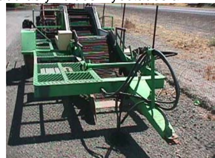
Líneas hidráulicas de la cosechadora de papas
